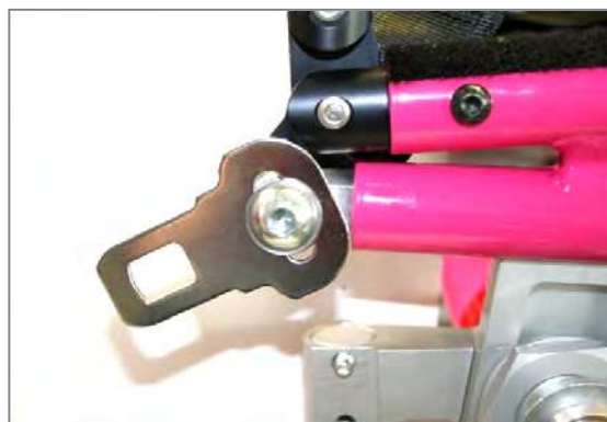
Figure 153 : Attache d'ancrage sur le châssis arrière avec languette de fermeture pour le rétracteur arrière
