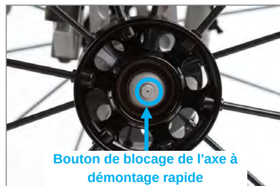
Figure 70 : Bouton de blocage de l'axe à démontage rapide au centre de l'axe de roue
