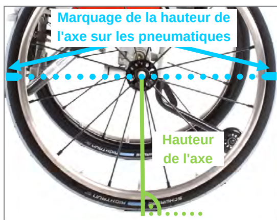
Figure 72 : Marquage de la hauteur de l'axe à l'avant et à l'arrière sur les deux pneumatiques
