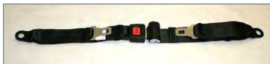
Figure 157 : Ceinture ventrale avec fermeture, les ferrures de fixation pour l'attache sur les ancrages et les deux languettes de fermeture pour la fixation au choix de la ceinture oblique à l'épaule
