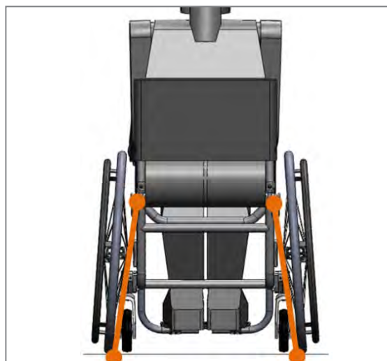
Figure 163 : Position des rétracteurs avant et arrière avec un angle de tension maximum et des points d'attache (vue de l'arrière)
