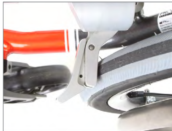
Figure 145 : Élément de frein reposant sur le pneu
