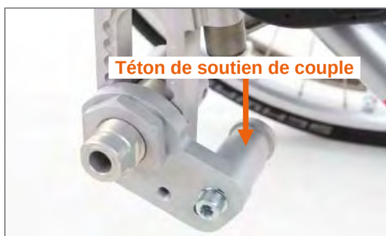
Figure 80 : Téton de soutien de couple monté sur le produit (vue du côté sans roue arrière)
