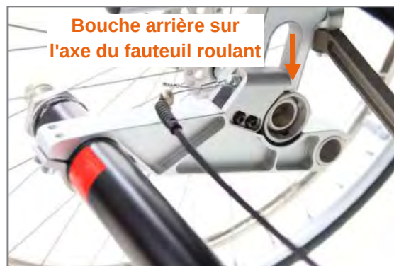
Figure 82 : Allongement d'empatement posé (vue du côté intérieur du produit)
