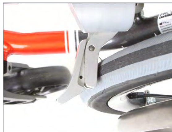
Figure 141 : Élément de frein reposant sur le pneu
