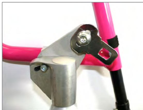
Figure 154 : Plaque d'écartement du roulement avec languette de fermeture du rétracteur avant
