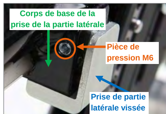
Figure 61 : Pièce de pression M6 dans le corps de base de la prise de la partie latérale vissée
