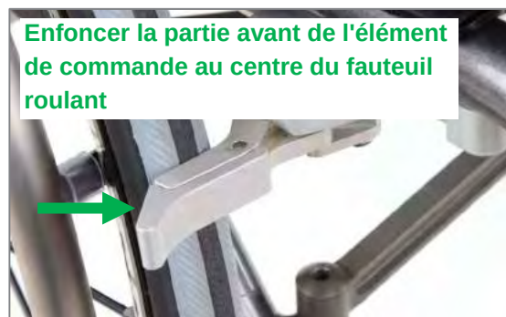
Figure 138 : Frein intégral fermé ; l'ouverture s'effectue en appuyant sur l'élément de commande au centre du fauteuil roulant
