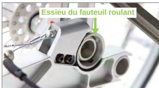
Figure 79 : Axe du fauteuil roulant (vue du côté intérieur du produit)
