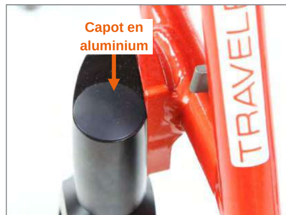
Figure 88 : Capot en aluminium
