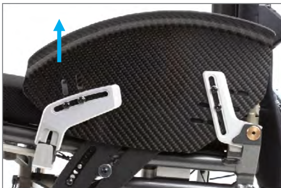
Figure 56 : Protège-vêtements tiré vers l'avant en dehors de la « prise de tôle latérale vissée »
