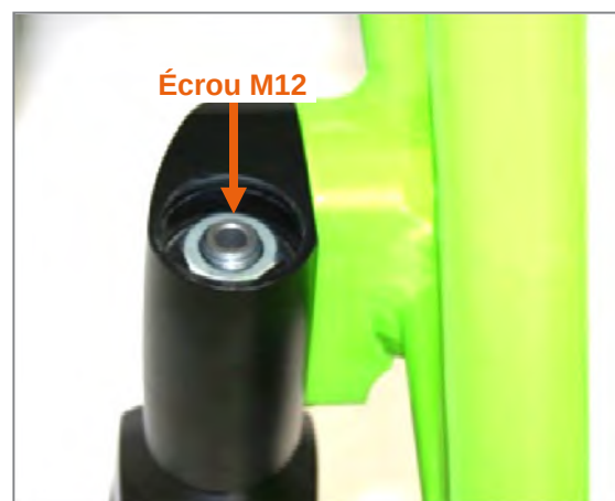
Figure 89 : Capot en aluminium retiré et écrou M12 visible
