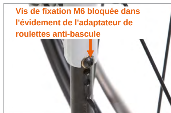
Figure 118 : Roulettes anti-basculé enclenchées correctement
