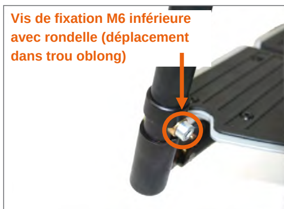
Figure 109 : La vis de fixation M6 inférieure (clé de 5 mm) peut être positionnée dans le trou oblong
