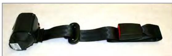
Figure 158 : Ceinture oblique d'épaule automatique avec renvoi et fermeture
