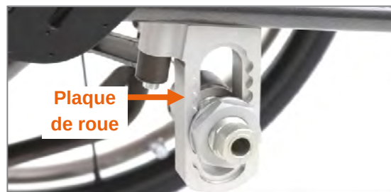
Figure 6 : Plaque de roue pour le réglage de la hauteur d'assise arrière
