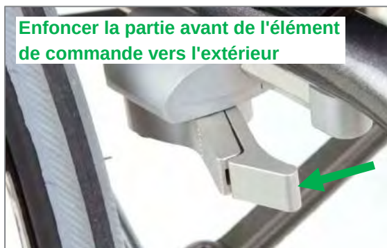
Figure 136 : Frein intégral ouvert ; la fermeture s'effectue en enfonçant vers l'extérieur l'élément de commande
