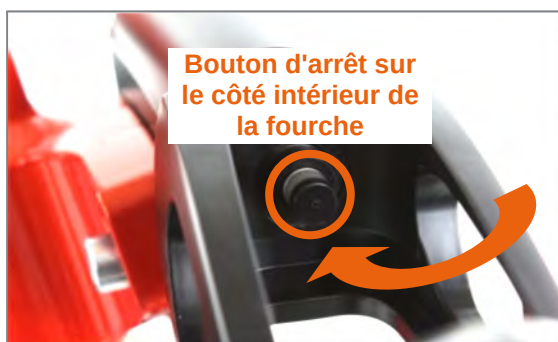
Figure 90 : Fourche de roue avant avec axe à démontage rapide et bouton de blocage
