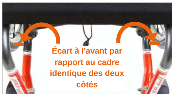
Figure 75 : Écart à l'avant par rapport au cadre
