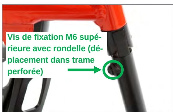
Figure 112 : La vis de fixation M6 supérieure (clé de 4 mm) peut être positionnée dans la trame perforée
