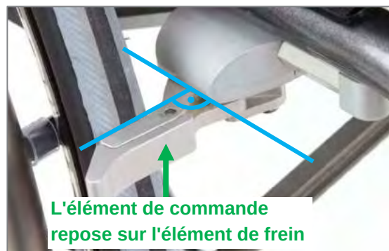
Figure 137 : Frein intégral fermé ; élément de frein perpendiculaire au support de frein
