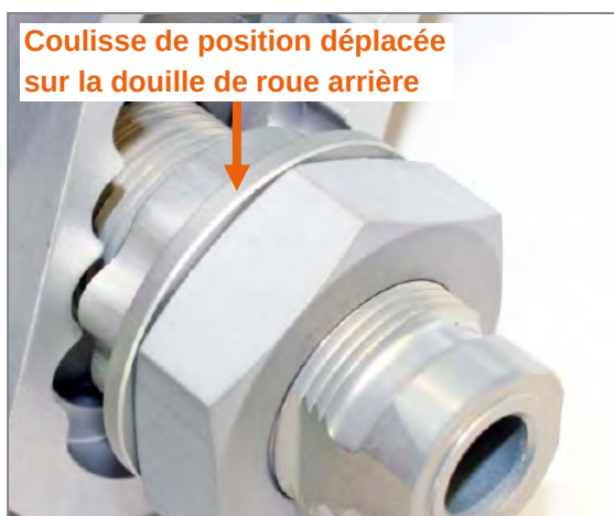
Figure 10 : Écrou de fixation en aluminium desserré et coulisse de position déplacée sur la douille de roue arrière
