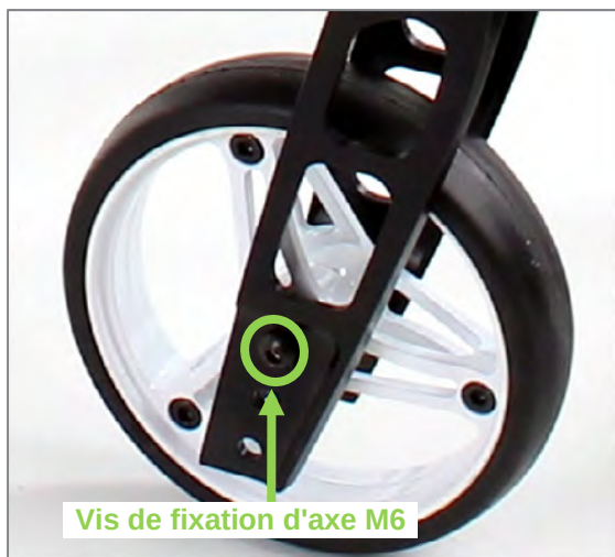
Figure 83 : Vis de fixation M6 d'axe de la roue avant
