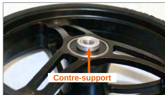
Figure 85 : Contre-support sur la roue avant
