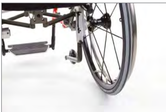
Figure 116 : Position passive des roulettes anti-basculé
