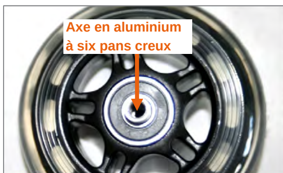
Figure 84 : Roue avant avec axe en aluminium
