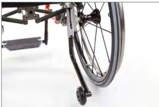
Figure 115 : Position de service des roulettes anti-basculé
