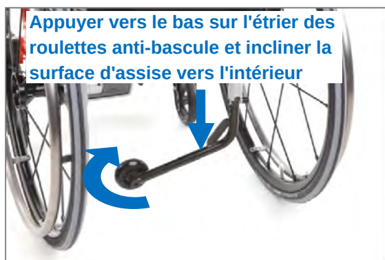
Figure 119 : Amener les roulettes anti-basculage en position passive
