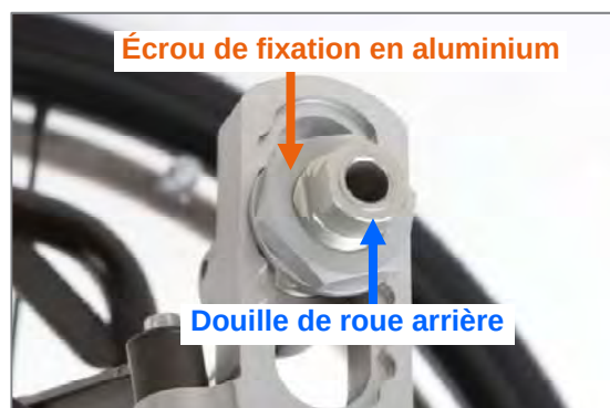
Figure 7 : Écrou de fixation en aluminium et douille de roue arrière
