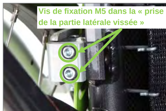
Figure 66 : Prise de la partie latérale vissée avec trous oblongs et vis de fixation M5 sur le corps de base de la prise de la partie latérale (vue du bas)
