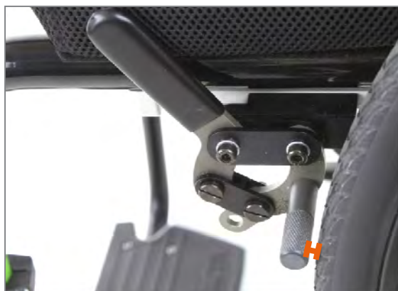
Figure 132 : Écart entre les patins de frein et les pneus d'env. 3 mm à 4 mm maximum lorsque le frein est ouvert
