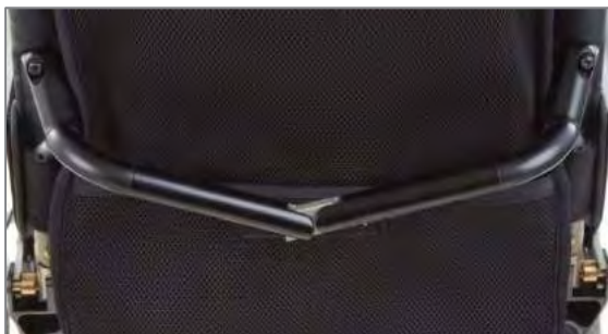
Figure 2 : Barre de renfort du dossier déverrouillée
