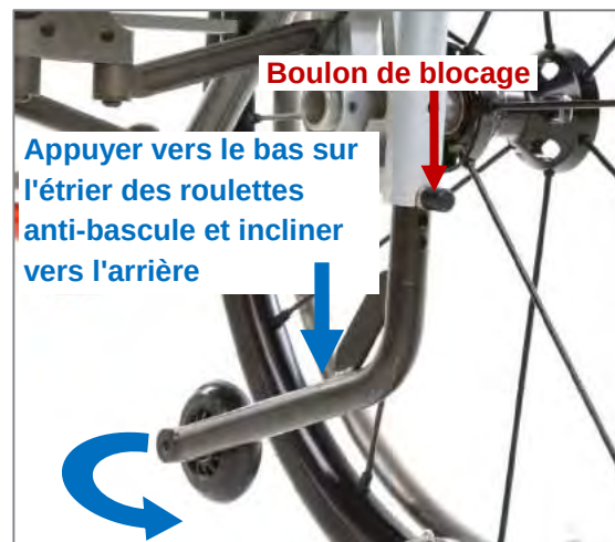
Figure 117 : Amener les roulettes anti-basculé en position de service
