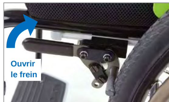
Figure 130 : Frein fermé ; l'ouverture s'effectue en tirant le levier de frein vers le haut
