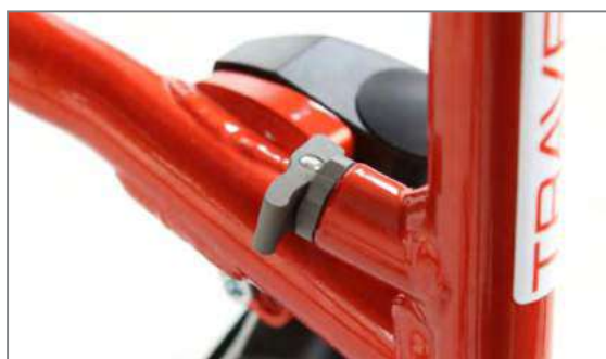
Figure 96 : Levier du boulon d'arrêt fermé
