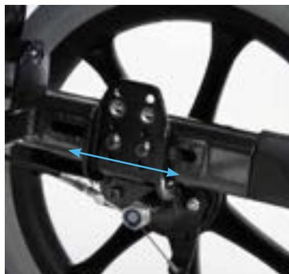
Le centre de gravité est ajustable en continu sur 90 mm pour optimiser la maniabilité et la stabilité du fauteuil.
